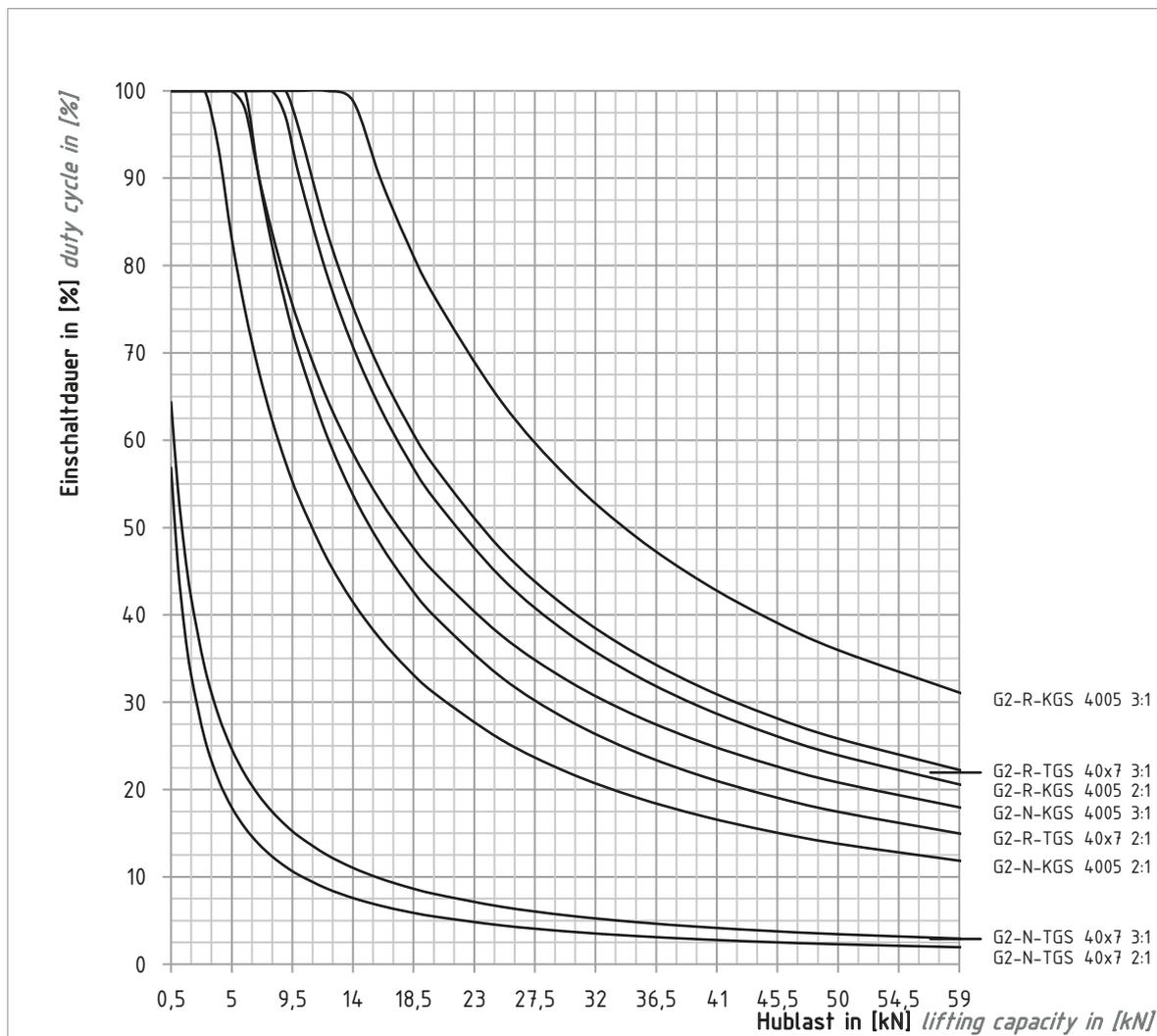
Um die Einschaltdauer  $ED_r/h$  für andere Drehzahlen zu ermitteln wird die Einschaltdauer in [%] mit dem Drehzahlfaktor  $fn_{neff}$  multipliziert:
