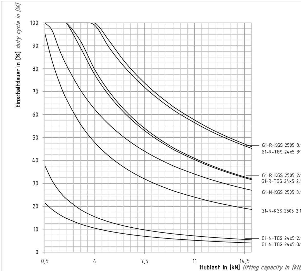
Um die Einschaltdauer  $ED_n/h$  für andere Drehzahlen zu ermitteln wird die Einschaltdauer in [%] mit dem Drehzahlfaktor  $fn_{neff}$  multipliziert:
