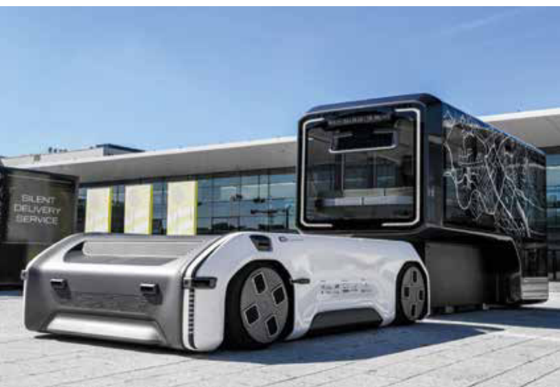
Modulares Fahrzeugkonzept: Das Fahrgestell des Prototyps fährt unter die Nutzeinheit. Bild: DLR
